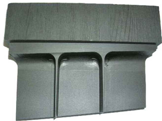
使用 EAGLE 火花机粗加工和精加工后的电极
