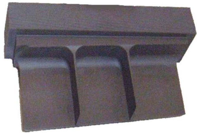
使用普通火花机粗加工后的电极
