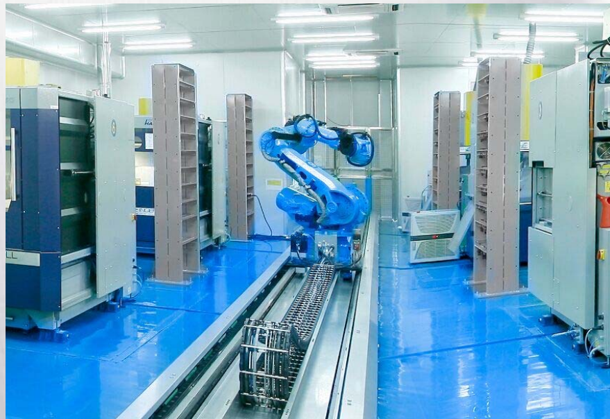
模具加工中心“Professional”由 GANTRY 450C，SPEED 550 和自动送料系统组成
