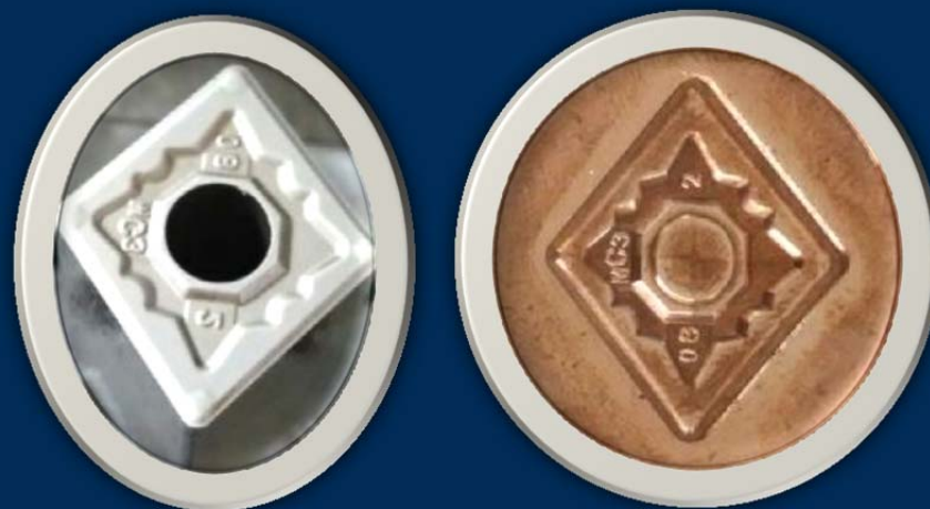
乌铜电极加工硬质合金刀片模具
