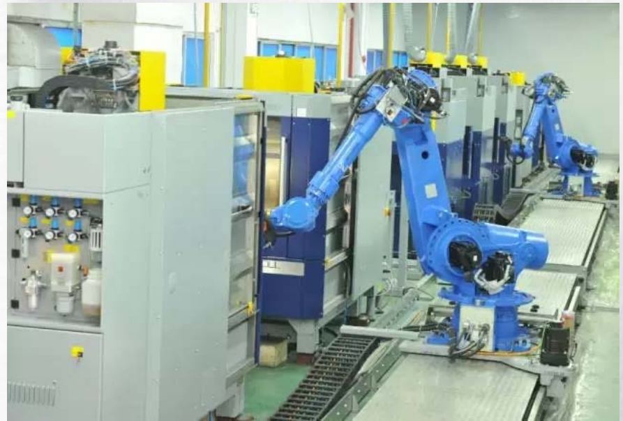
模具加工中心“Professional”由 GANTRY 450C，SPEED 550 和自动送料系统组成
